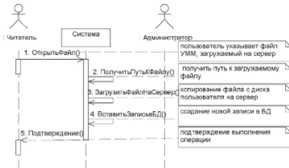
Рис. К.6. Диаграмма последовательностей для варианта использования П.1 «Добавить файл УММ для обработки»
