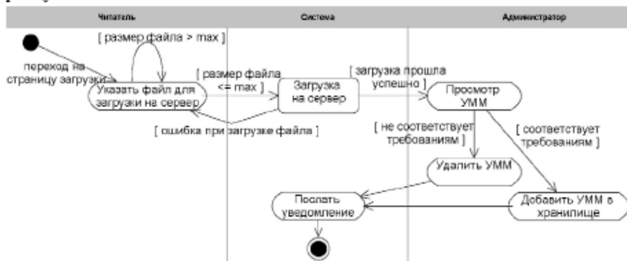
Рис. К.8. Диаграмма деятельности варианта использования П.1 «Добавить файл УММ для обработки»
