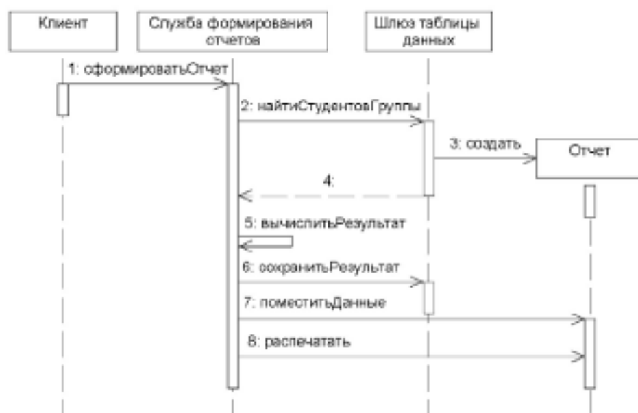
Рис. 5. Формирование отчета в системе, построенной на базе паттерна «сценарий транзакций»
