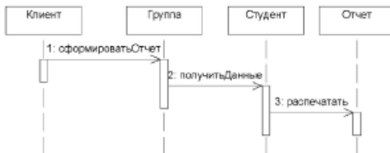
Рис. 6. Формирование отчета в системе, построенной на базе паттерна «модель предметной области»
